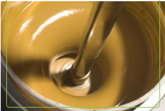
Figura 3 Formación correcta de la "Dona". Correcta formación de líneas de flujo. (Agudelo, 2013)
